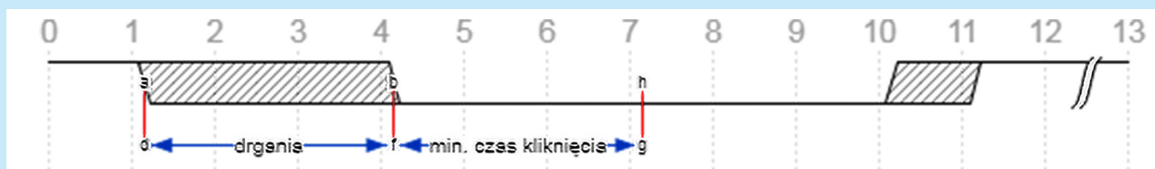
Rysunek 3. Uproszczona ilustracja funkcji eliminującej drgania styków
