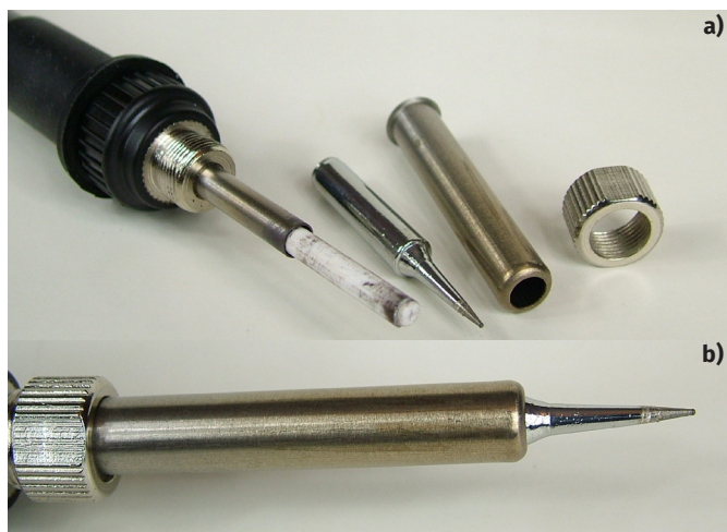
Fotografia 1. Standardowy (ołówkowy) grot lutownicy ST-50D, a) elementy mocowania, b) grot gotowy do pracy
