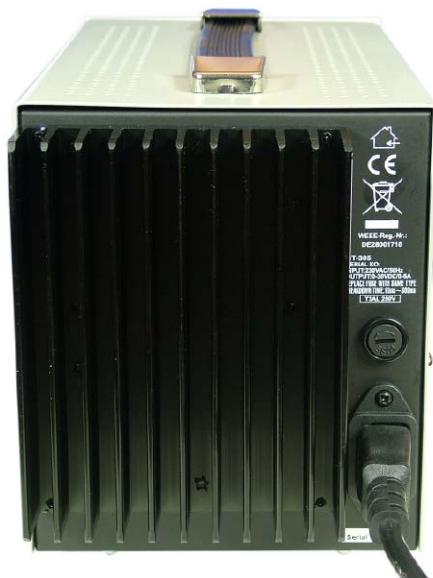
Fotografia 1. Tylna ściana zasilacza z zamontowanym na niej radiatorem
