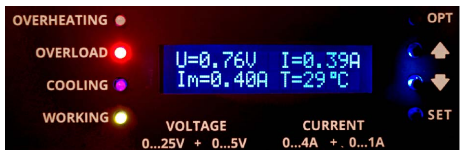
Fotografia 21. Panel sterujący zasilacza w trakcie pracy z ograniczeniem prądowym w trybie ciągłym (@ Ovldwait=5000\ \mu\text{s} )
