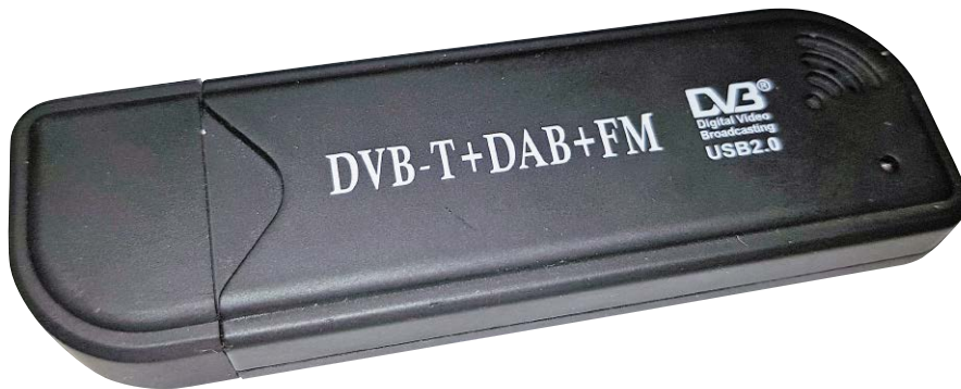
Fotografia 1. Przykładowy, typowy tuner DVB-T z interfejsem USB
