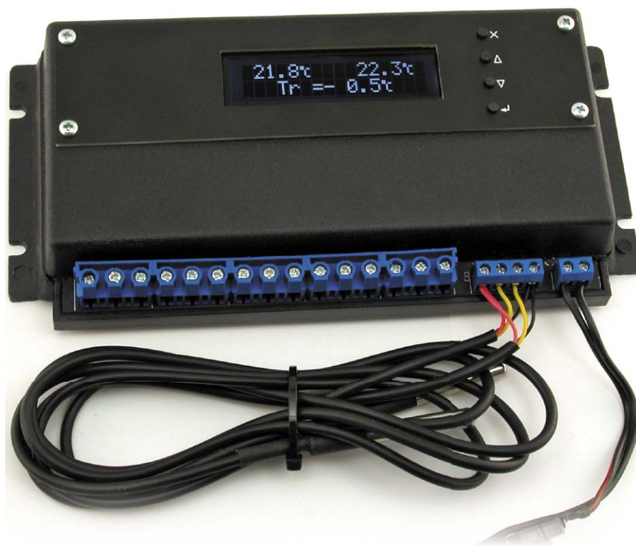
Fotografia 6. Wygląd zmontowanego termostatu umieszczonego w obudowie
