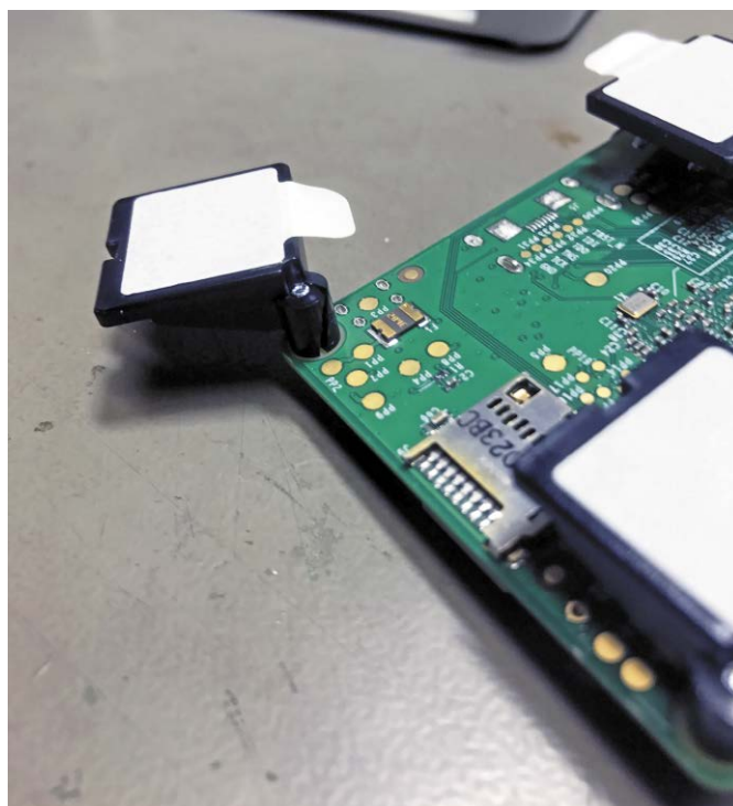
Fotografia 1. Akcesoryjne, przyklejane słupki do montażu PCB pozwalają na swobodną aranżację modułów we wnętrzu obudowy
