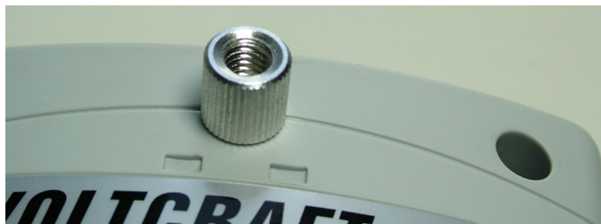
Fotografia 2. Śruba fotograficzna służąca do mocowania testera na statywie
