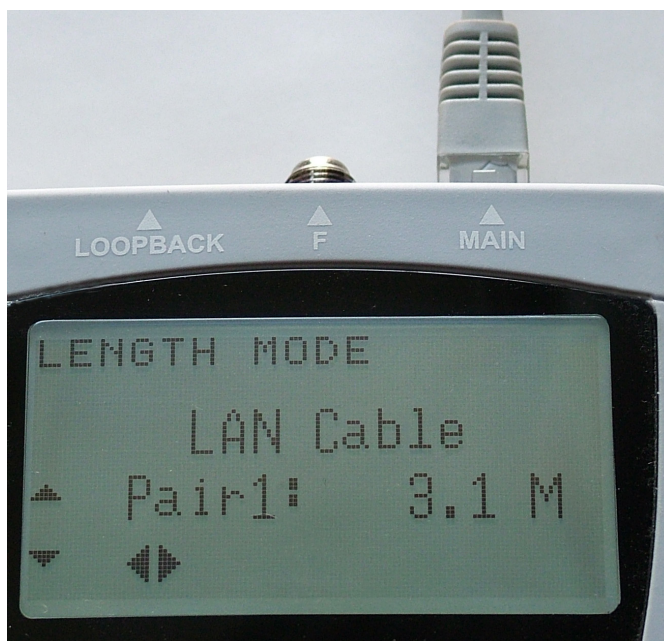
Fotografia 7. Wynik pomiaru długości kabla UTP
