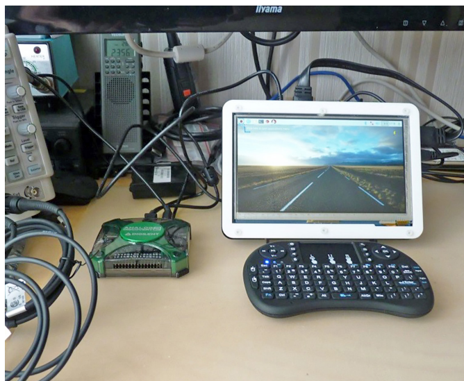
Fotografia 5. Konfiguracja systemu pomiarowego z RPi3 i AD2
