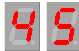
Rysunek 5. Sygnalizowanie rozdzielczości 1 sekundy – ustawiony czas 45 sekund
