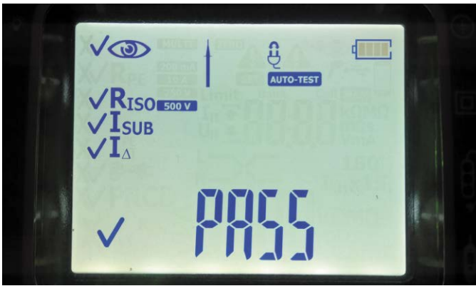
Fotografia 7. W górnej części ekranu jest widoczna ikona informująca o konieczności użycia dodatkowego kabla potężeniowego
