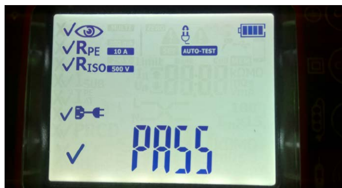
Fotografia 3. Pozytywny wynik testu kabla zasilającego IEC
