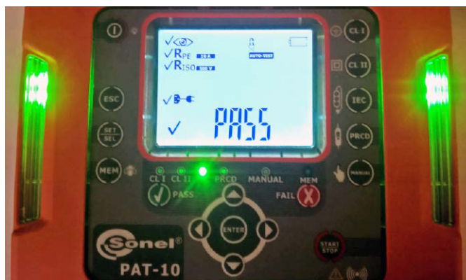
Fotografia 5. Sygnalizacja pozytywnego wyniku testu za pomocą zielonych diod LED
