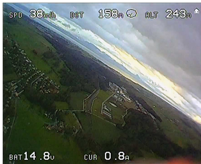
Fotografia 1. Obraz oglądany na monitorze FPV. Wokół ekranu rozmieszczono komunikaty telemetry
