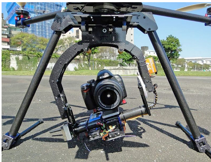
Fotografia 4. Przykładowy gimbal 3-osiowy z zamontowanym aparatem fotograficznym
