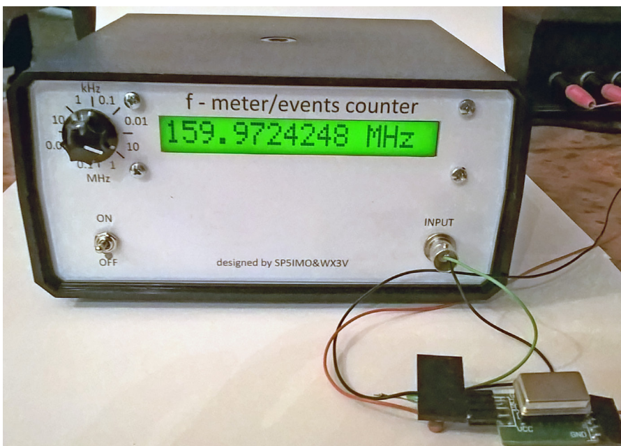
Fotografia 7. Pomiar częstotliwości generatora kwarcowego TTL 160 MHz
