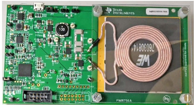
Rysunek 6. Płytki nadajnika BQ501210-756 (za notą TI)
