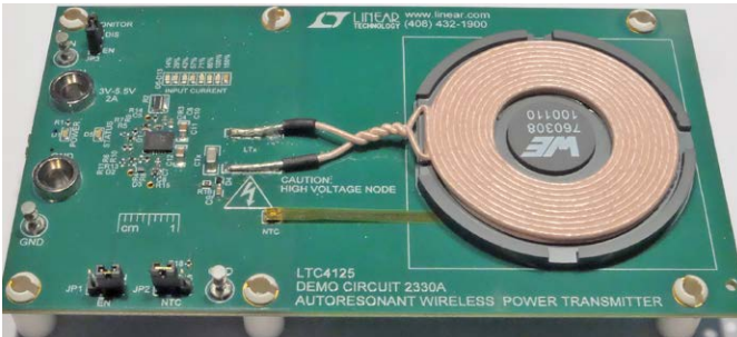
Rysunek 3a. Płytki nadajnika LTC4125 zestawu DC2386A-A/B
