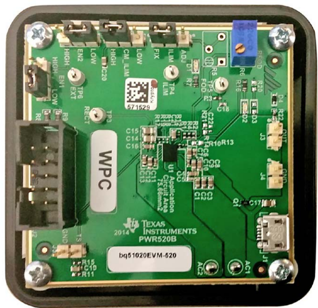
Rysunek 7. Płytki odbiornika bq51020EVM-520 (za notą TI)
