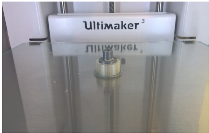
Fotografia 11. Gałka po zakończeniu wydruku – dookoła widać materiał podporowy, na którym zastał ułożony kotnierz gałki
