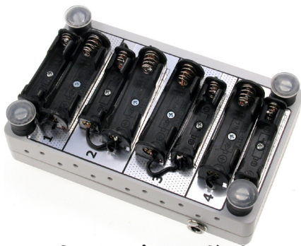
Fotografia 6. Montaż przewodów do wyprowadzeń koszyków
