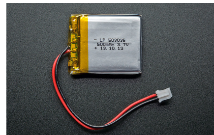
Rysunek 4. Akumulator użyty w projekcie
