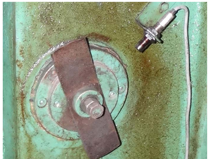
Fotografia 2. Inicjatory zamontowane na wrzecionie
