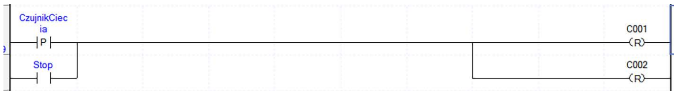
Rysunek 15. Wyzerowanie liczników C001 i C002 oraz umożliwienie ponownego uruchomienia napędu wrzeciona
