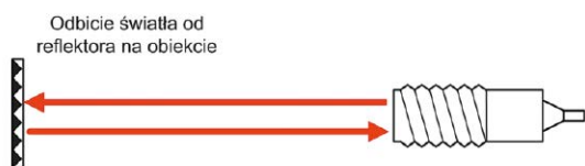
Rysunek 6. Sensor fotoelektryczny wykorzystujący bezpośrednie odbicie od zwierciadła na obiekcie
