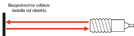
Rysunek 5. Sensor fotoelektryczny wykorzystujący bezpośrednie odbicie od obiektu
