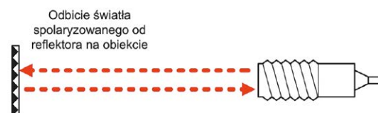
Rysunek 7. Sensor fotoelektryczny wykorzystujący odbicie światła spolaryzowanego od obiektu
