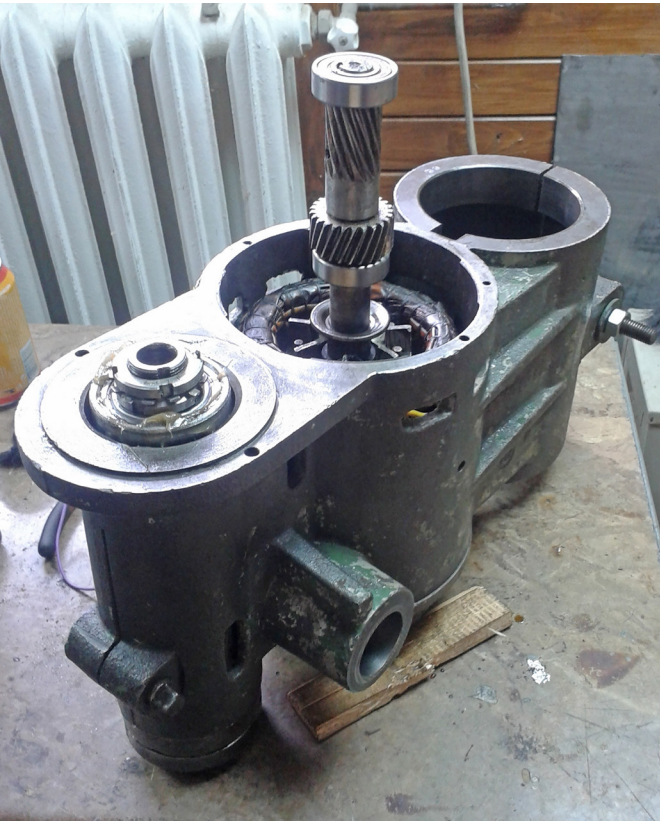
Fotografia 2. Korpus z silnikiem indukcyjnym w trakcie czyszczenia
