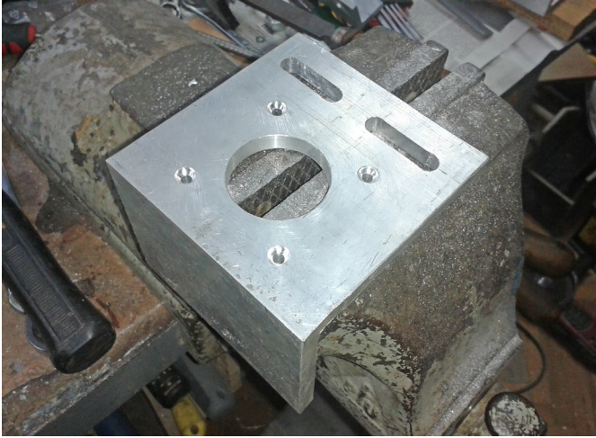
Fotografia 6. Mocowanie silnika oraz koła zębatego
