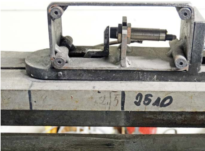
Fotografia 3. Moduł cięcia składa się z prowadnicy drutu, na której umieszczona jest blokada mechaniczna i czujnik wykrycia dojazdu drutu do blokady
