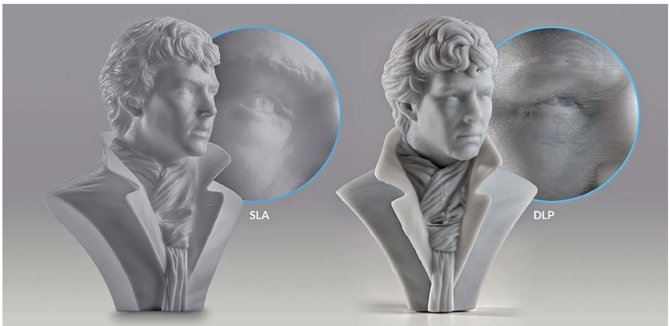
Rysunek 3. Porównanie wydruków wykonanych w technologiach SLA i DLP (źródło: https://formlabs.com/ )
