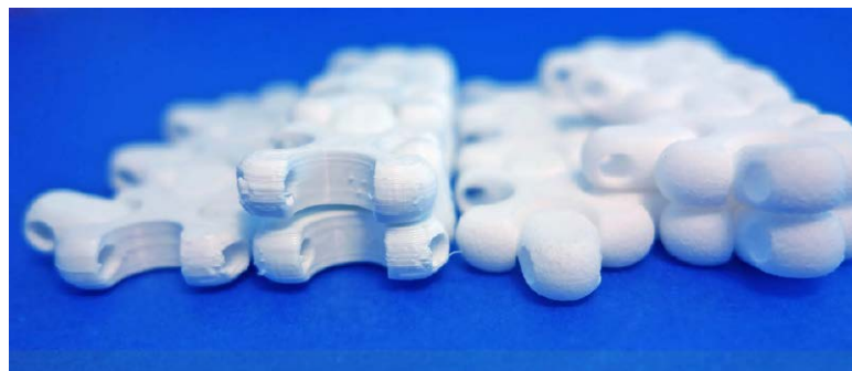
Fotografia 5. Porównanie technologii FDM (po lewej) i SLS (po prawej). Źródło: https://www.sculpteo.com
