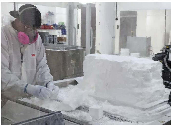
Fotografia 4. Obiekt wydrukowany w technologii SLS (źródło: https://3dprintingindustry.com )
