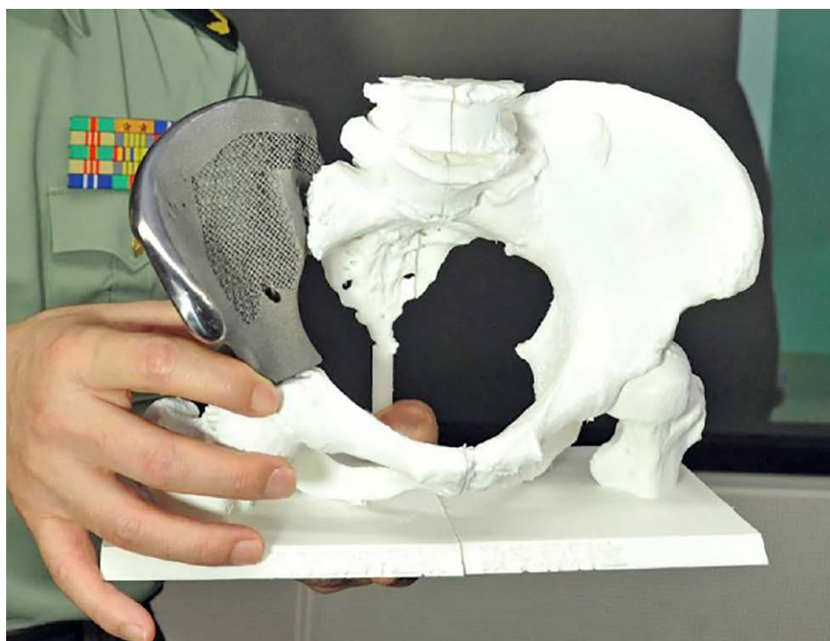
Fotografia 6. Na zdjęciu implant kości miednicy wykonany z tytanu w technologii SLM, pozostała część (model poglądowy) wykonano w technologii SLS. Źródło: http://www.3ders.org
