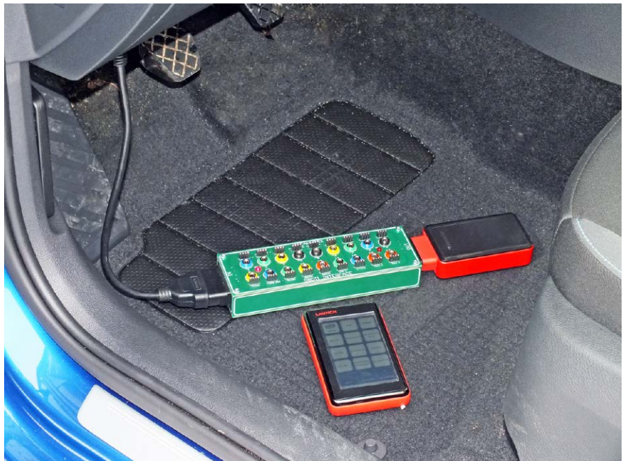
Fotografia 7. Praktyczne wykorzystanie CAN-BOX w samochodzie w połączeniu z testerem diagnostycznym
