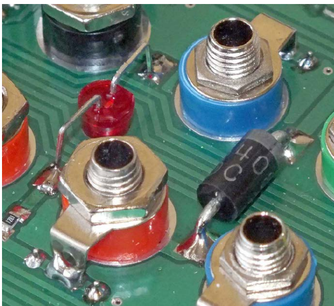
Fotografia 12. Sposób montażu diody LED, diody prostowniczej D2 i gniazd bananowych
