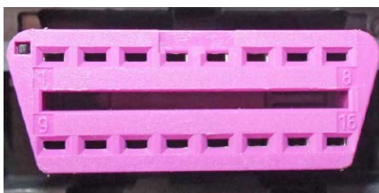
Fotografia 1. Gniazdo OBDII instalowane w samochodach osobowych
