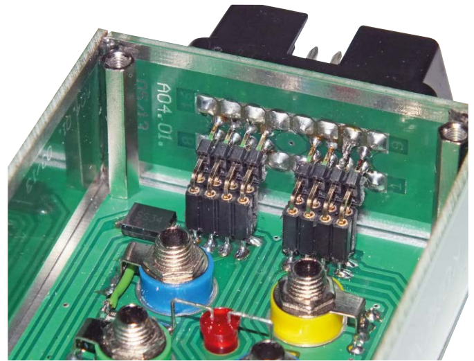
Fotografia 16. Sposób połączenia wyprowadzeń złączy z płytką z gniazdami
