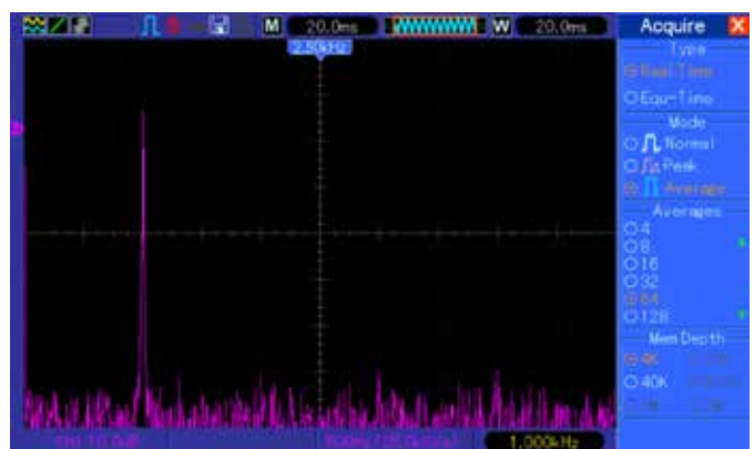
Rysunek 11. Widmo amplitudowe sygnału sinusoidalnego 1 kHz
