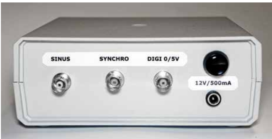
Fotografia 16. Przykładowe wykonanie i opis tylnego panelu generatora
