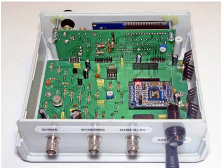
Fotografia 15. Widok zmontowanego generatora od tyłu
