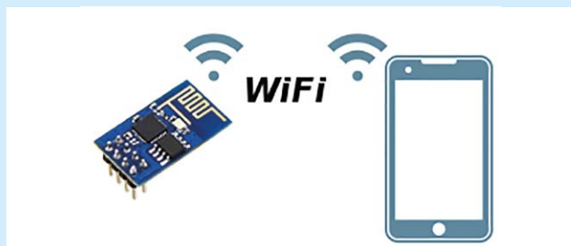
Rysunek 3. Konfiguracja, w której moduł komunikuje się bezpośrednio z urządzeniem sterującym
