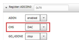
Rysunek 3. Konfiguracja wejścia przetwornika A/C
