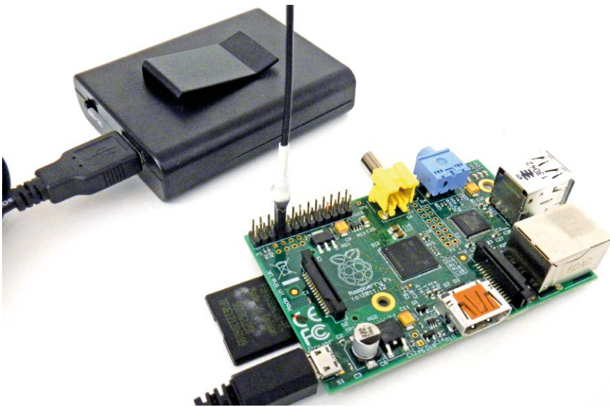
Rysunek 5. Raspberry PiRate Radio z akumulatorem i usztywnioną anteną, do nadawania radia na otwartym powietrzu
