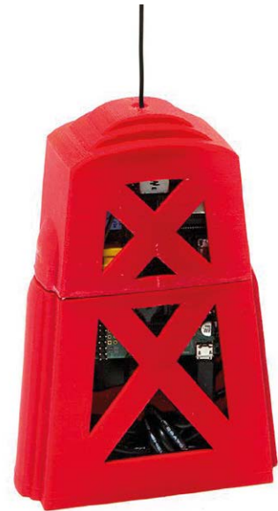
Rysunek 6. Atrakcyjna obudowa do Raspberry PiRate Radio, wydrukowana na drukarce 3D. Jej projekt jest dostępny bezpłatnie pod adresem: https://goo.gl/xitA1
