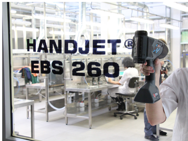
Fotografia 9. Drukowanie na szybie z odbiciem zwierciadlanym
