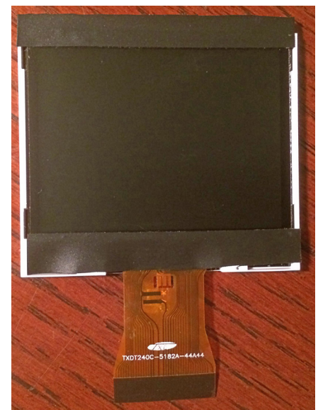
Fotografia 5. 2,5-calowy wyświetlacz, oklejony paskami czarnej taśmy izolacyjnej
