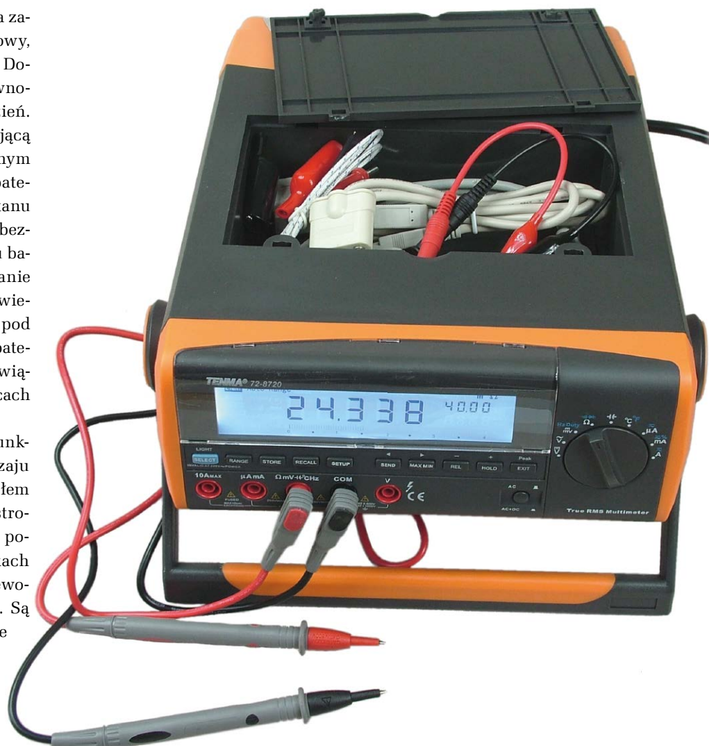
Fotografia 1. Pojemnik na akcesoria dostępny po otwarciu pokrywy na górze obudowy
