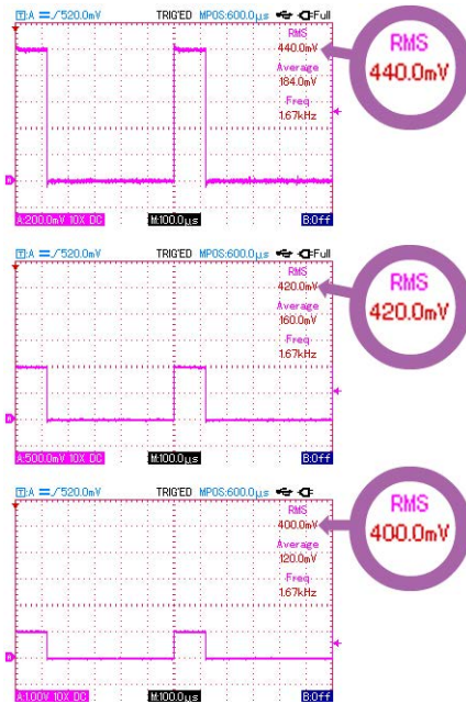
Rysunek 5. Wpływ doboru czułości kanału na pomiar napięcia RMS
