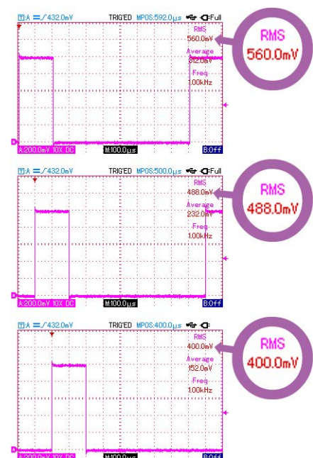
Rysunek 4. Różne wskazania napięcia RMS wynikające z nieprawidłowych nastaw oscyloskopu
