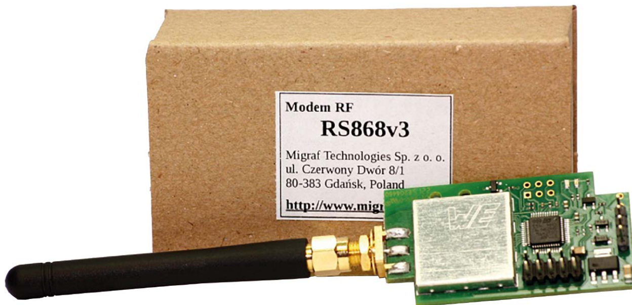
Rysunek 4. Moduł RS868v3 firmy Migraf Technologies, przeznaczony do bezprzewodowej komunikacji pomiędzy urządzeniami korzystającymi z interfejsu RS232
