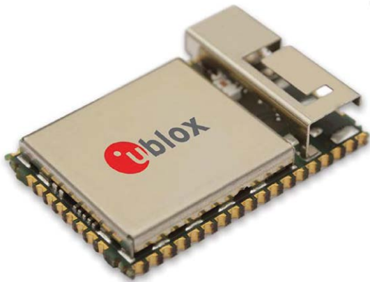
Fotografia 2. Moduł ODIN-W262, obsługa Wi-Fi, BLE i Bluetooth Classic, wbudowana antena
