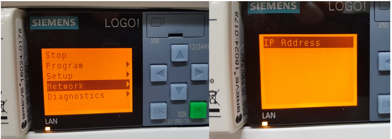
Fotografia 1. Ustalenie adresu IP sterownika – uruchomienie menu nastaw
