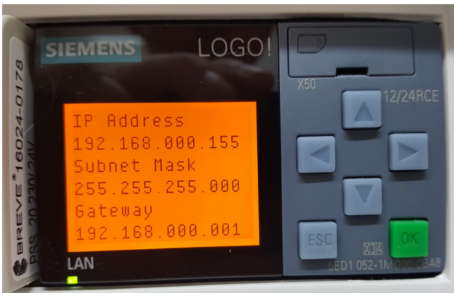
Fotografia 2. Ustalenie adresu IP sterownika – ustawienie parametrów
