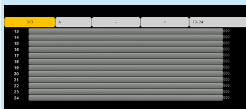
Rysunek 8. Jeżeli ustaliliśmy, że wyświetlanych faderów będzie 12, to pierwszy ekran będzie wyświetlał kanały 1...12, a po dotknięciu „+” będą wyświetlane kanały 13...24
