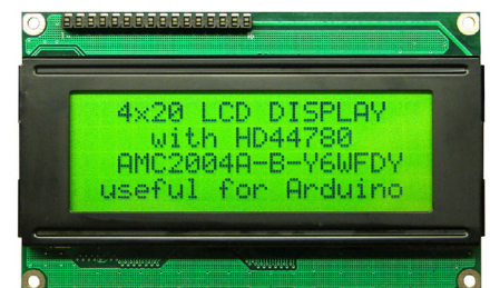
Fotografia 8. Wyświetlacz LCD, jaki z łatwością można podłączyć do Arduino
