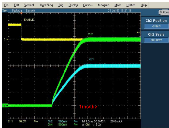
Rysunek 5. Tryb proporcjonalny – wszystkie napięcia zasilające osiągną punkt regulacji w tym samym czasie
