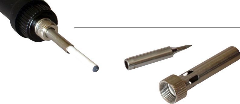
Fotografia 2. W stacji zastosowano lutownicę z efektywną grzałką ceramiczną
