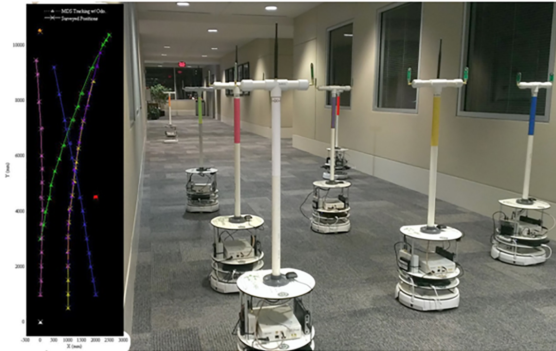
Rysunek 2. Stanowisko testowe CSOT demonstrujące możliwości lokalizacji. Po lewej stronie pokazano wykres szacowanej i zbadanej pozycji
