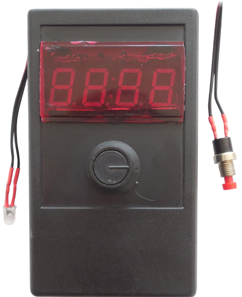
Fotografia 6. Licznik zamknięty w obudowie
