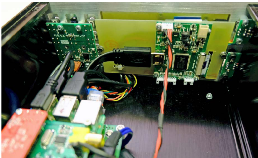
Fotografia 7. Sposób montażu wewnątrz obudowy odtwarzacza
