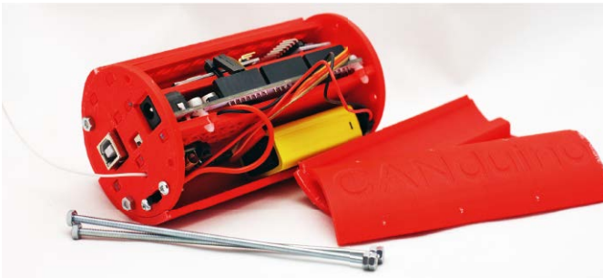
Fotografia 3. Płytkę Arduino Due zamontowano w obudowie
