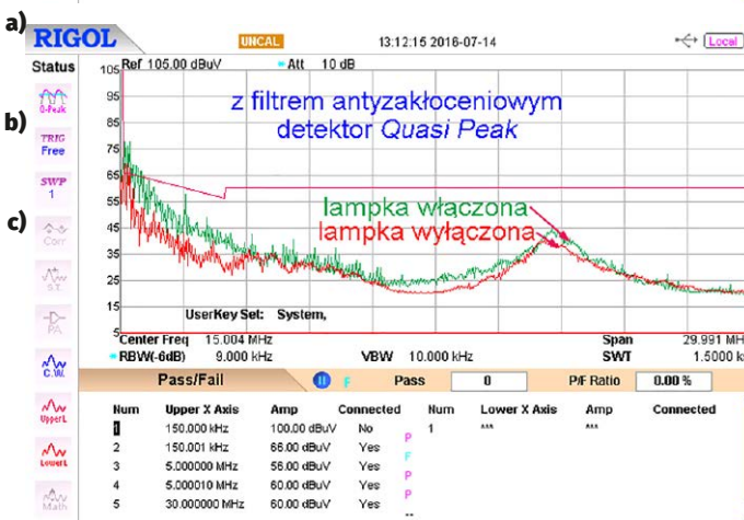
Rysunek 15. Badanie emisyjności przewodzonej lampki LED USB z adapterem 230 V: a) bez zewnętrznego sieciowego filtru antyzakłóceńowego, b) z filtrem antyzakłóceńowym, c) z filtrem antyzakłóceńowym, pomiar z detektorem Quasi Peak
