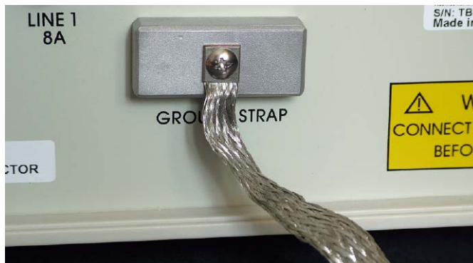
Rysunek 14. Taśma uziemiająca stabilizatora impedancji sieci (LISN)
