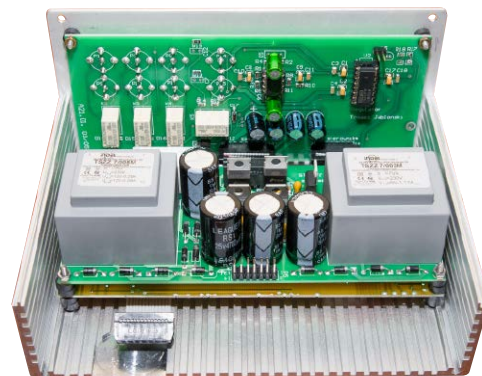
Fotografia 22. Płytkę regulatora zamontowaną na panelu tylnym
