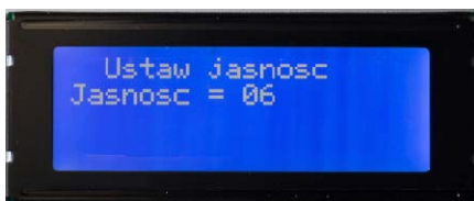
Rysunek 33. Ustawianie jasności podświetlenia wyświetlacza
