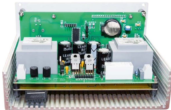
Fotografia 19. Zamontowanie płytki zasilacza w obudowie z panelem przednim
