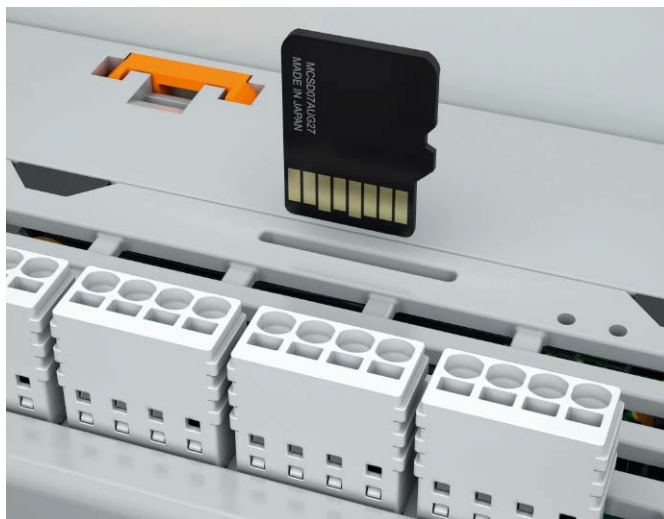
Fotografia 3. Złącza wtykowe pozwalają w łatwy sposób wyprowadzić np. wyprowadzenia interfejsów 1-Wire lub PC. Dostęp do karty microSD także jest łatwy, bo nie trzeba demontować urządzenia
