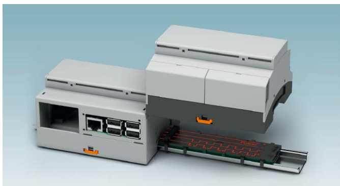
Fotografia 1. Łatwa rozbudowa systemu o kolejne moduły BC (o szerokości od 17,8 do 161,6 mm) dzięki bezobstugowej, 16-biegunowej magistrali montowanej pod obudowami
