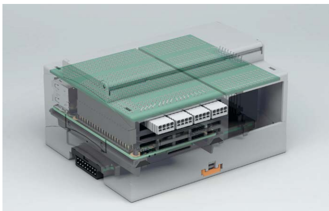
Fotografia 2. Obudowa mieści nie tylko same Raspberry PI, ale również ma miejsce na dodatkowe płytki uniwersalne – można je wykorzystać w dowolny sposób lub przygotować własną. Pusta przestrzeń zmieści np. kątowe wyprowadzenie złącza HDMI
