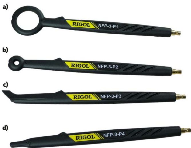
Fotografia 2. Sondy firmy Rigol służące do pomiarów bliskiego pola
