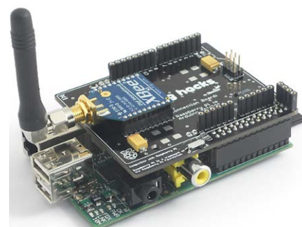
Fotografia 22. Zestaw w postaci Raspberry PI, modułu ZigBee i przejściówki pomiędzy RPI a XBee
