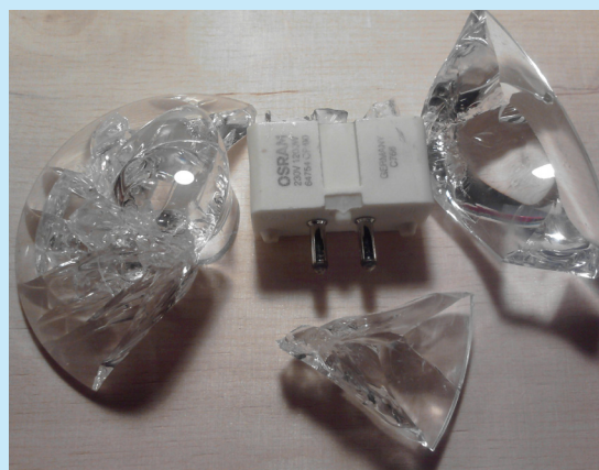
Fotografia 1. Soczewka reflektora stłuczona na skutek wybuchu żarówki
