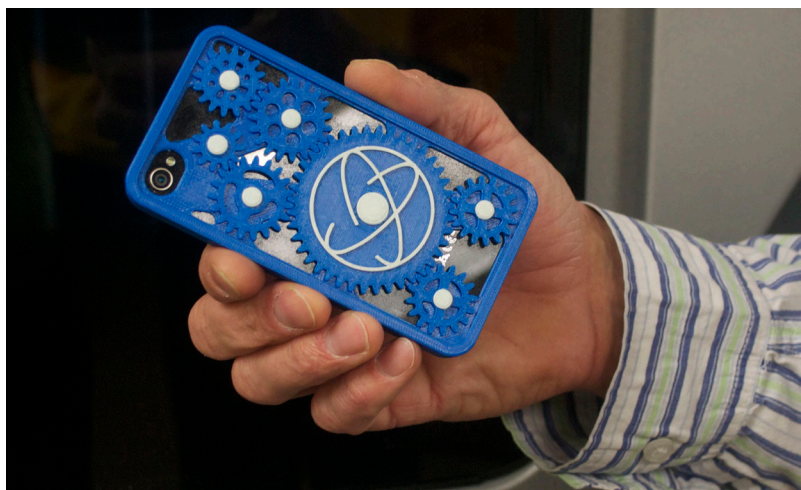
Fotografia 18. Obudowa na iPhone, wykonana w technologii druku 3D
