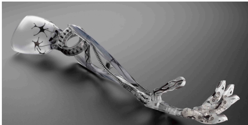
Fotografia 19. Wydrukowana proteza ramienia
