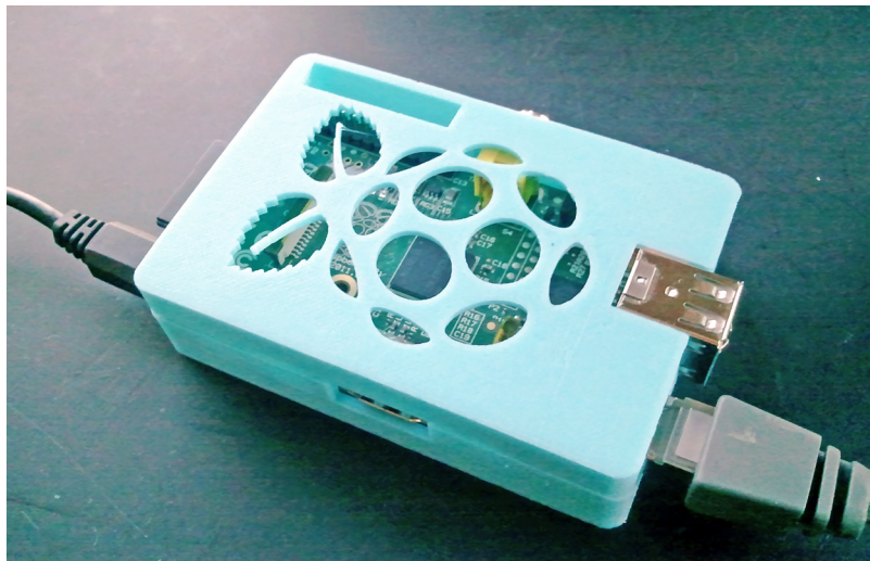
Fotografia 17. Obudowa Raspberry PI, wydrukowana na drukarce 3D
